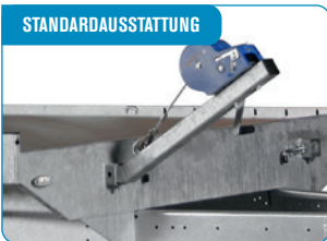
Seilwinde. Wenn Fahrzeuge auf die Ladefläche gezogen werden müssen.
