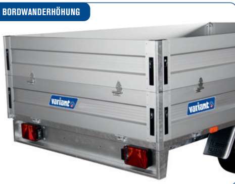
Erhöhen das Raumvolumen des Anhängers. Alle Bordwände sind mit Scharnieren und sind klapp- und abnehmbar. Feine und reinigungsfreundliche Innenseite, Höhe 35 cm.
