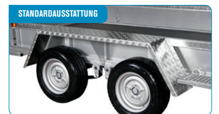
Alu-Kotflügel. Solide und robust, können auch als Trittbrett verwendet werden.
