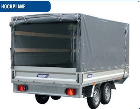
Kräftige Qualität, geschweißtes Gestell und querlaufende Aussteifung. Innenhöhe 210 cm wenn montiert.
